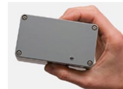
Een gps-traceringsysteem wordt op een onopvallende plaats aangebracht en vaak meespotsen in de machinekleur. De kastjes zien eruit alsof ze normaal bij de machine horen.
